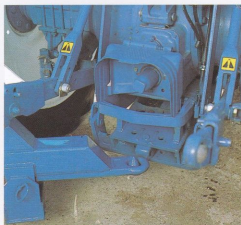
Den nya hitchen ger ökad lyftkraft och bättre frigångshöjd
