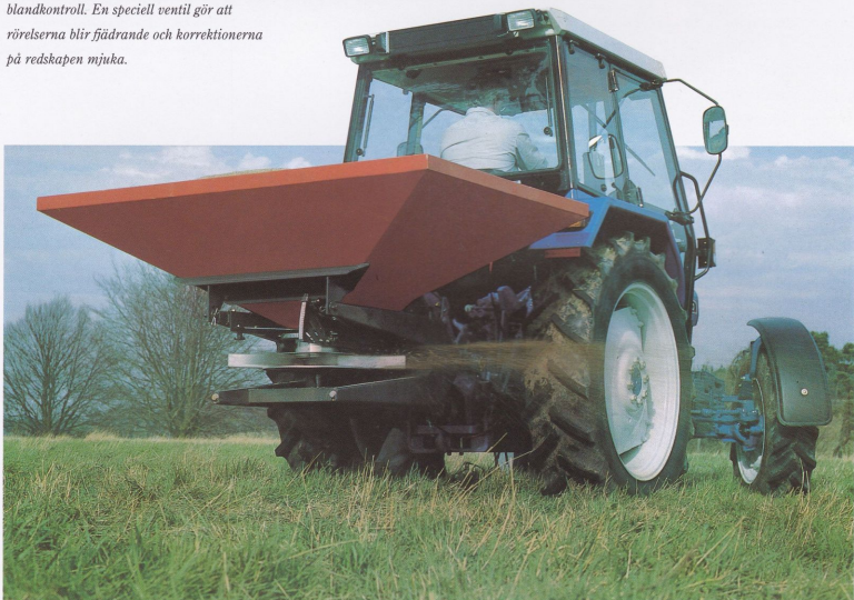
3-punktslyft kategori II med extracylinder ger en lyftkapacitet av upp till 2682 kg för hantering av tunga, helburna redskap
